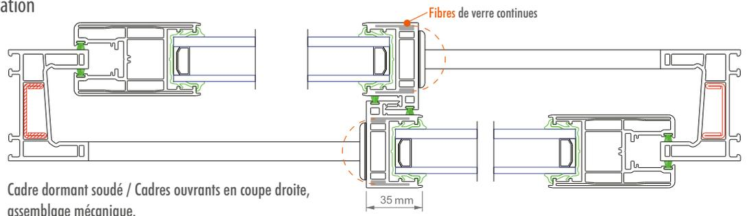
Cadre dormant soudé / Cadres ouvrants en coupe droite, assemblage mécanique.
